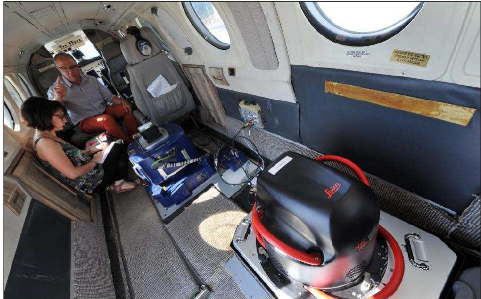
■ C'est grâce à ces caméras de haute précision (au premier plan en rouge, au second plan en bleu) que plus de 16 000 clichés ont été réalisés de cet avion, à environ 1 000 mètres du sol. Photo Claude ESSERTEL
