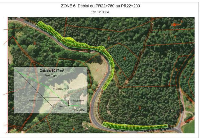
Réalisation en régie de pièges à cailloux et dégagements de visibilité Le MNT à permis l'estimation au plus juste des déblais ainsi que des entrées en terre.
