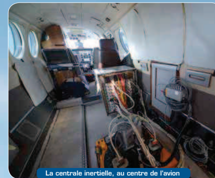
La centrale inertielle, au centre de l'avion
