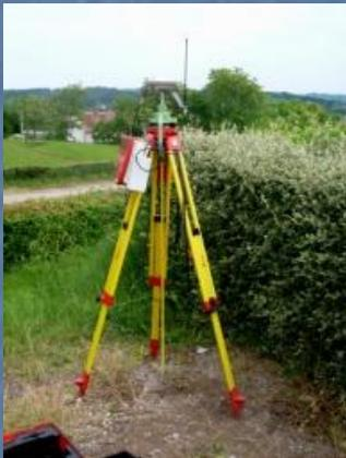
Station fixe positionnée sur un point de coordonnées géographiques connues. Permet de réaliser une correction des données obtenues au même instant par la station mobile afin d'obtenir une précision centimétrique.
