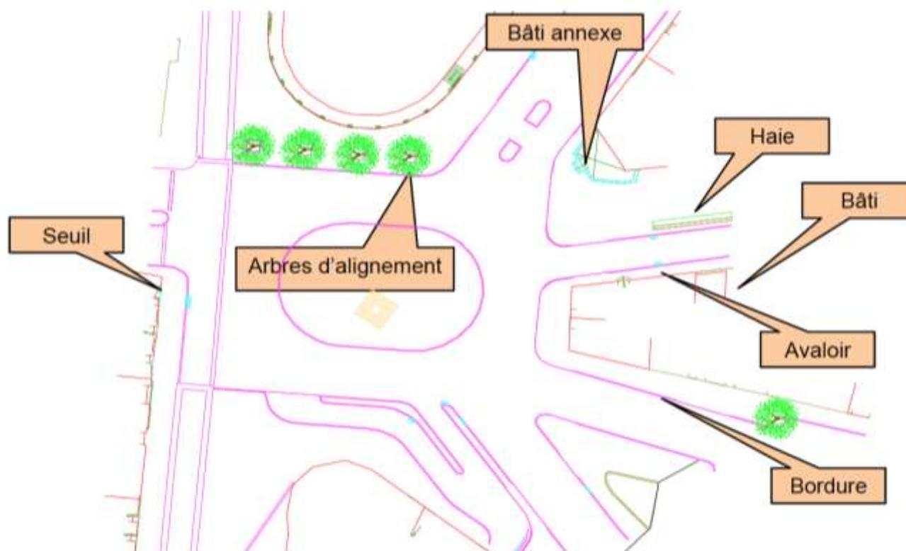
Figure n°12 : Extrait d'une proposition de PCRS (échelle : 1/200<sup>ème</sup>).
