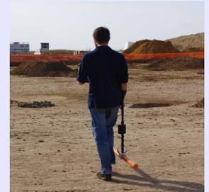
Rapidité de mesure (en continu), fort échantillonnage, positionnement GPS, gamme de mesure adaptée...
