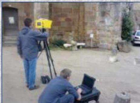
▪ Acquisition de données à l'aide d'un Scanner 3D
