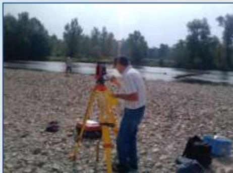
▪ Acquisition de données topographiques et bathymétriques à l'aide d'un DGPS et d'une station total.
